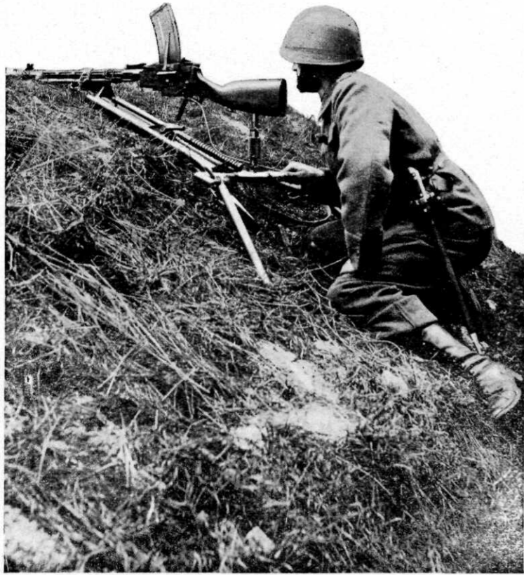
Lichte Madsen mitrailleur op lichte affuit in stelling op een aarden wal (Bowdenaftrekinrichting), automatisch vurend.
