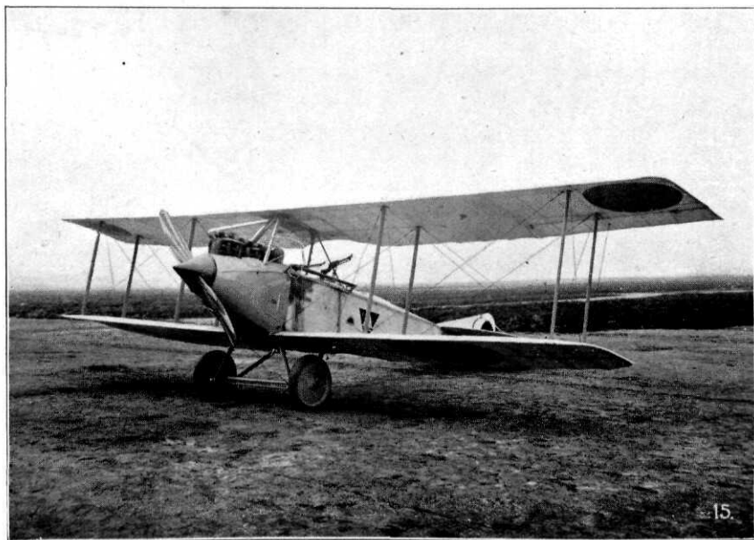
Verkenningvliegtuig, type Aviatik, bewapend met 2 Madsenmitrailleurs, beweegbaar langs een horizontalen stang.
