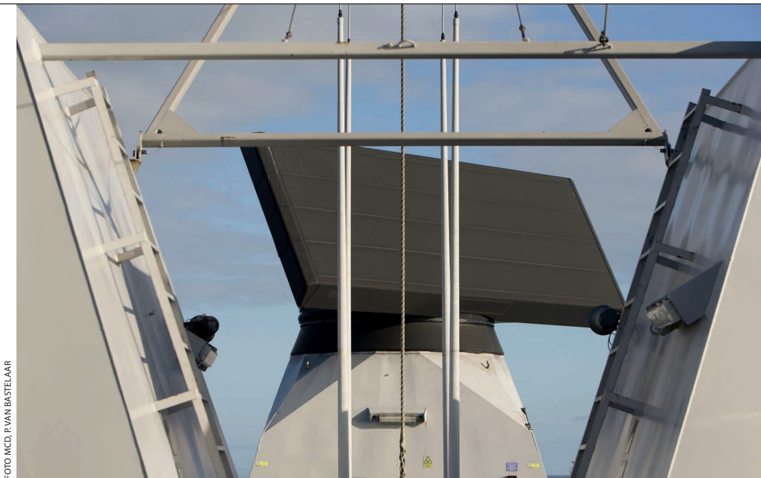
Zr.Ms. Zeven Provinciën, Smart L radar. Geeft een vliegtuig een correcte respons op een vereijderde ondervraging per IFF ('Identification Friend or Foe'), dan is het vriendschappelijk. Identificatiecriteria zijn echter nooit helemaal waterdicht
