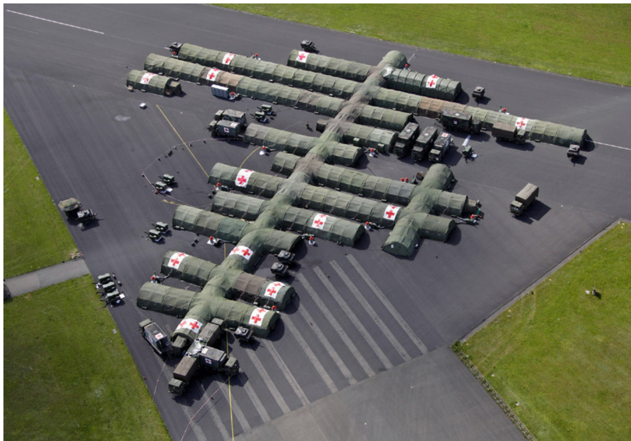
Luchtfoto van een Role 2E MTF. De meer statische Role 2 MTF's hebben een ontplooiingstijd van minimaal enkele dagen en hebben niet de middelen om zelfstandig te verplaatsen
